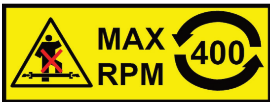
Attention à l'arbre en rotation ! La vitesse de rotation maximale autorisée et le sens de rotation de l'arbre de prise de force.
